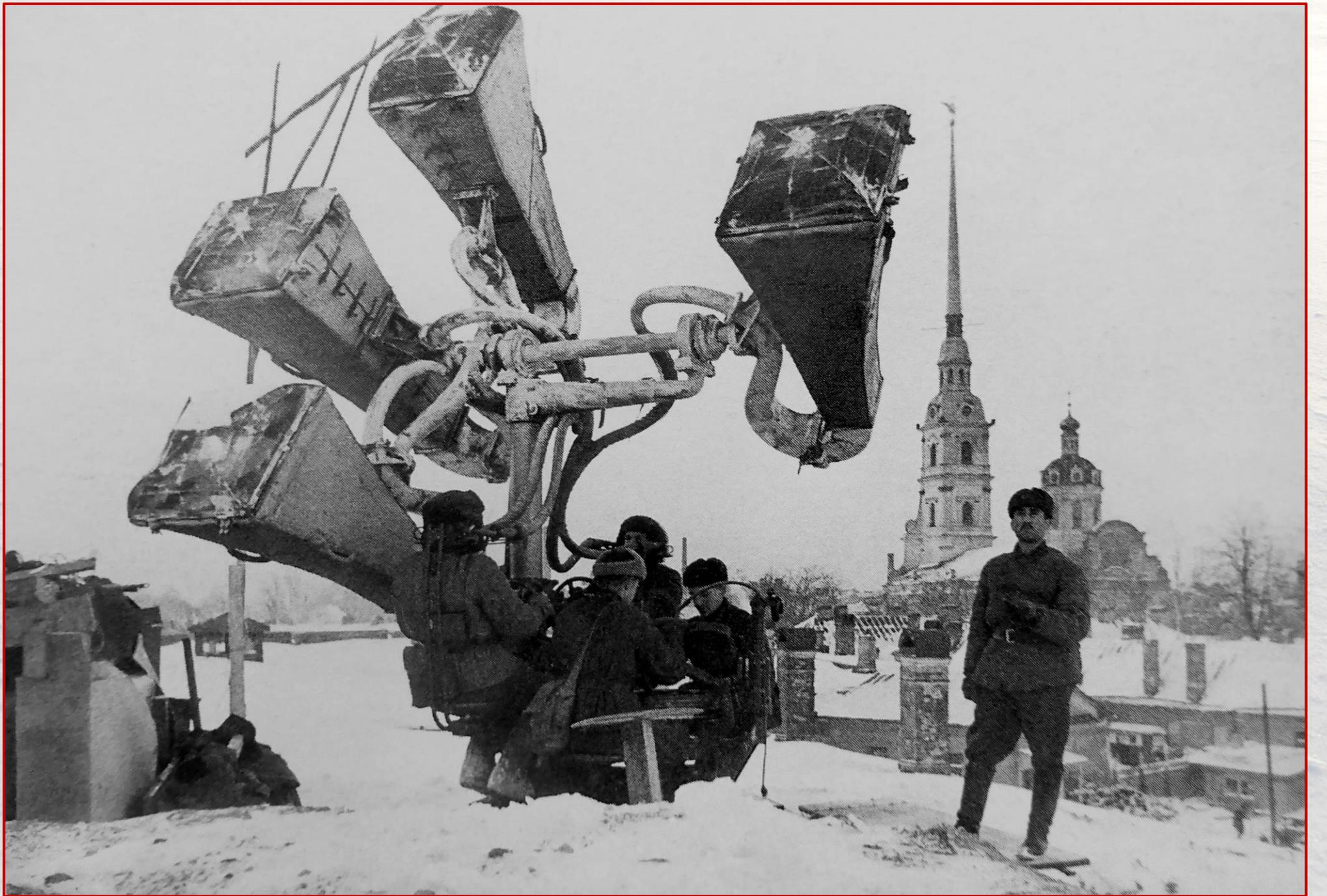
Во время блокады впервые в истории в действующие войска были призваны незрячие люди. Для обнаружения вражеских самолётов применялась поисковая система, которая состояла из прожектора, звукоулавливателя и поста управления. Главным звеном этой системы был «слухач» — оператор звукоулавливателя. ПВО города объявило набор незрячих добровольцев для службы «слухачами». После обучения в действующую армию в январе 1942 года были зачислены 12 лучших незрячих «слухачей».
